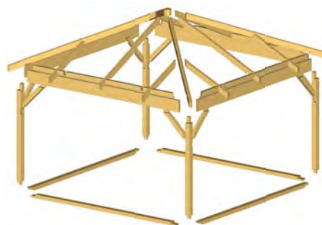
Abb. Konstruktion mit Fundamentrahmen
