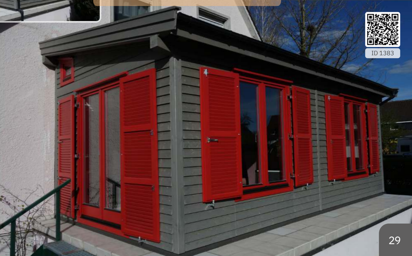
CARA EASY 3257 P Dachform: Pultdach Wandstärke: 28 mm, Wandaußenmaß (B/T): 320 x 570 cm Seitenwandhöhe: 220 cm, Firsthöhe: 300 cm Dachüberstand (V/H/L/R): 20, 0, 20, 20 cm, Dachneigung: 10 ° Fenster: 2 x DF 120 x 160, DF 120 x ... Optionales Zubehör: 1 x Dachrinne: 404Bx, 10 x Schindelpaket
